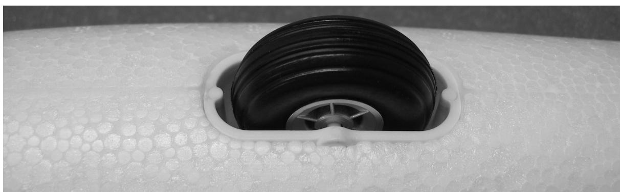
Der fertig in den Rumpf eingeklebte Radkasten.
