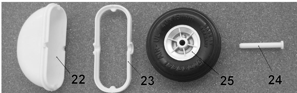
Die Abbildung zeigt die Einzelteile des Radkastens. Beim Verkleben darauf achten, dass kein Klebstoff in das Radlager gelangt.
